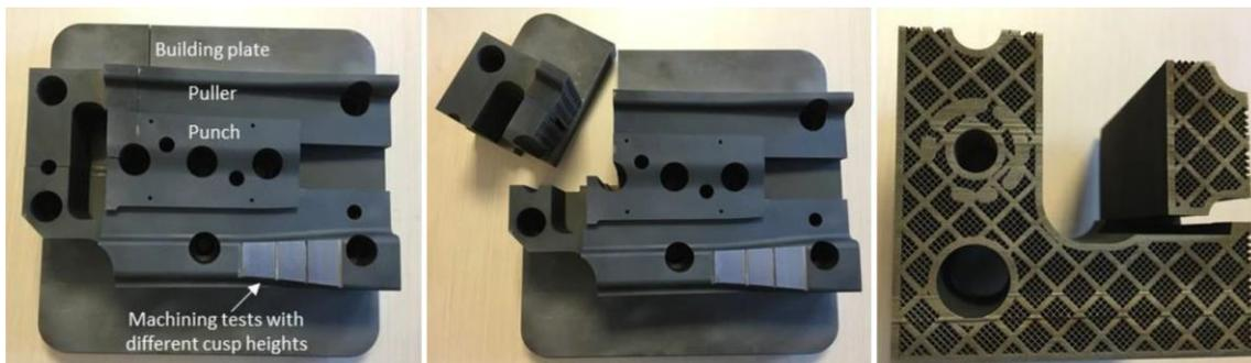
Figura 10. El extractor y el punzón impreso en 3D en la matriz progresiva. Material = DIN 1.2709. La estructura interna tiene un espesor capa exterior de 1,5 mm. [15]
