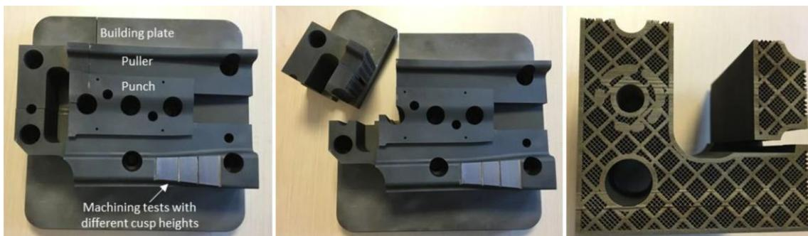
Figura 10. O puxador e punção impressos em 3D na ferramenta progressiva. Material = DIN 1.2709. A estrutura alveolar tem uma espessura de 1,5 mm na fachada/casca exterior. Adaptado a partir de [15].
