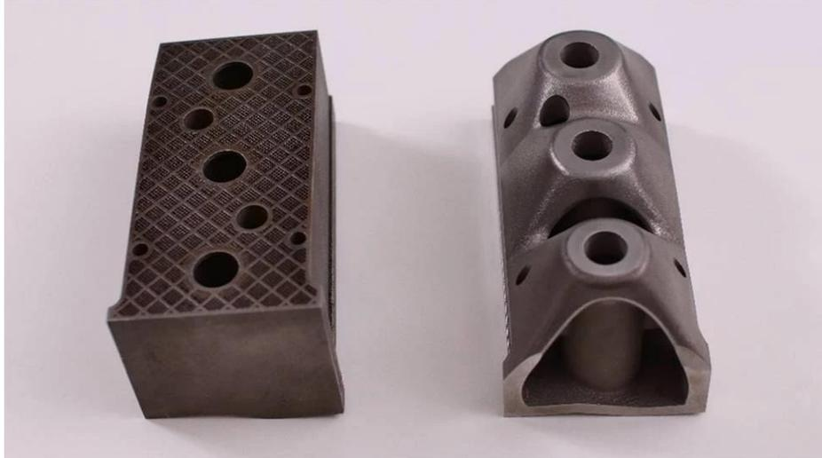
Figura 8. Uma punção industrial: Concebido convencionalmente e impresso em 3D com uma estrutura interna alveolar (esquerda) e impresso em 3D após otimização topológica (direita). Material = DIN 1.2709 em ambos os casos [14].
