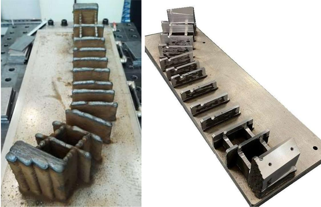
*Figura 6 : Peça fabricada com DED Arco - fio*
