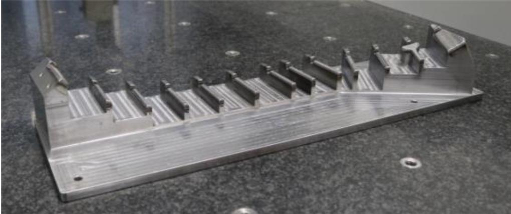
Figura 8 : Peça fabricada com DED LASER – Pó.
