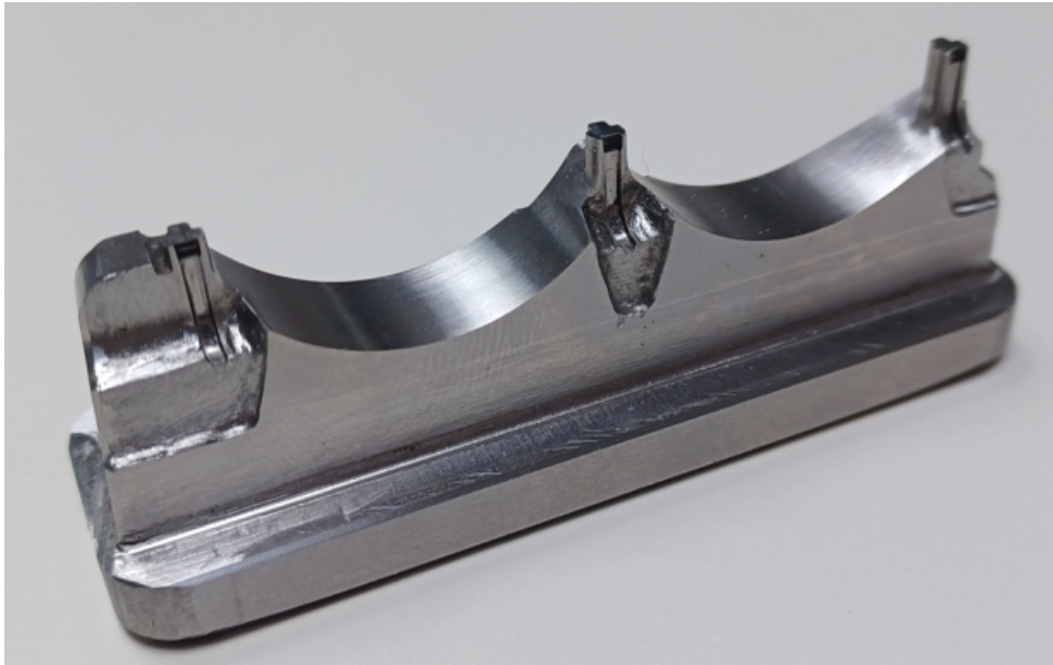
Figura 23: Geometria final do inserto L-PBF, após o acabamento.
