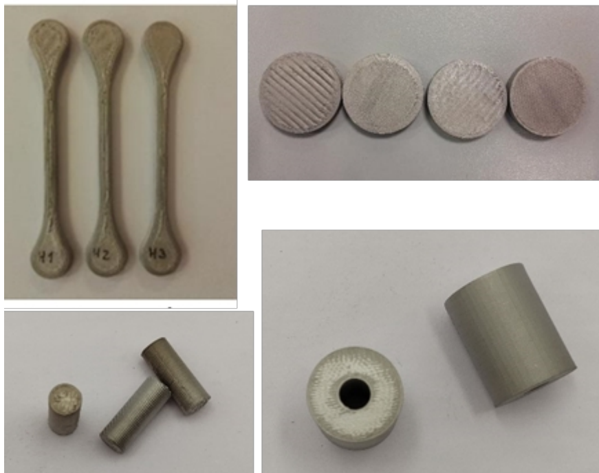
Figura 56: Provetes de tração, e outros, fabricados na orientação horizontal.
