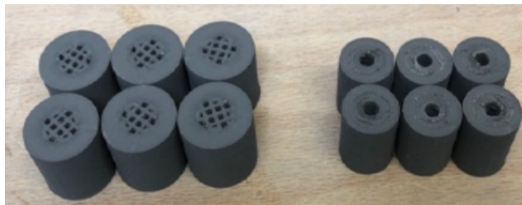
Figura 44: Amostras para melhorar a desaglomeração e a sinterização.
