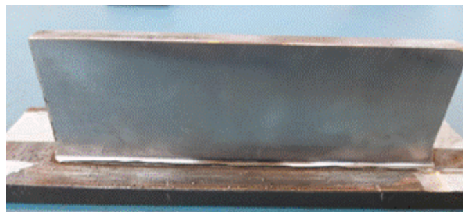
Figura 2. Paredes NNS fabricadas antes e depois da maquinação das superfícies
