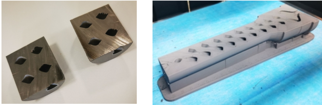
Figura 57. Pormenores dos canais de refrigeração adaptados
