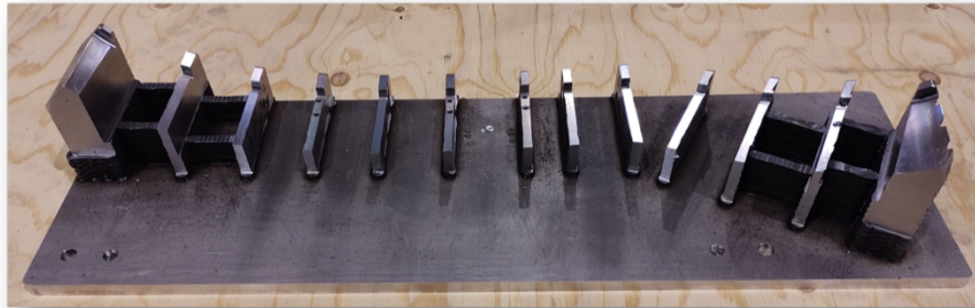
Figura 13. Maquinagem de zonas críticas do demonstrador
