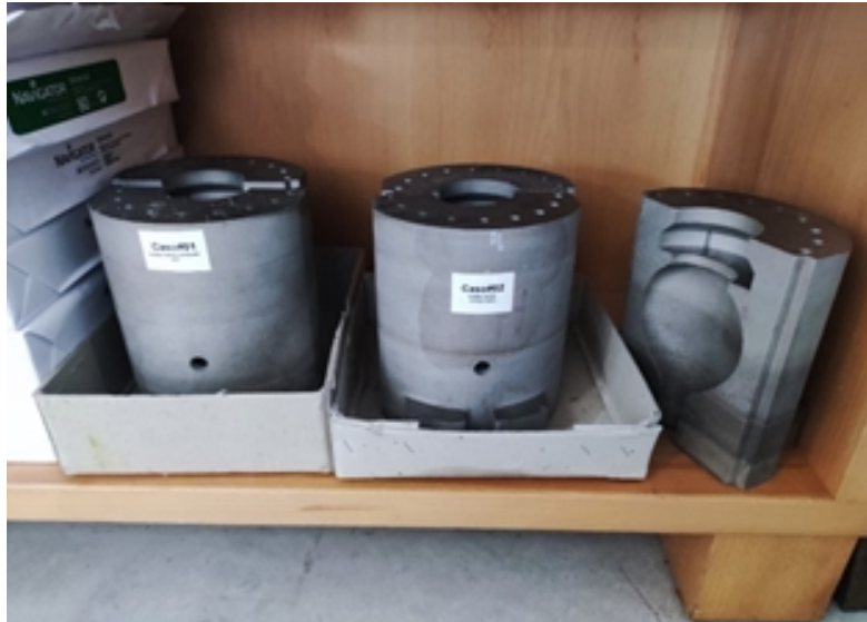
Figura 67: Molde para vidro fabricado por L-PBF.
