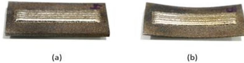
Figure 78 : Échantillons 6 et 7. Le gauchissement observé est important, surtout sur l'échantillon 7
