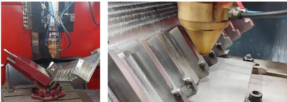
Figure 32 : Configuration de la fabrication de la pièce de démonstration en DED-PL
