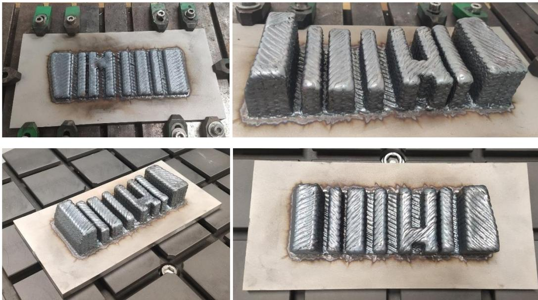
*Figure 8 : Fabrication du NNS avec le procédé DED Wire Laser*
