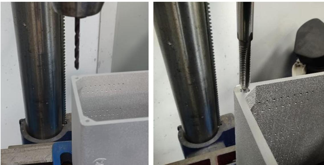
Figure 43 : (à gauche) Perçage et (à droite) filets obtenus manuellement pour D2 et D3
