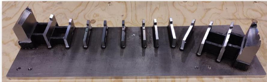
Figure 24 : Usinage des zones critiques du démonstrateur
