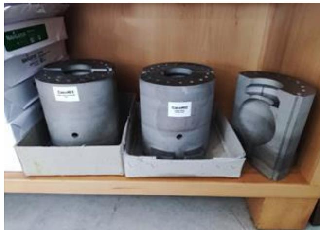
*Figure 83 : Moule pour verre fabriqué par L-PBF*
