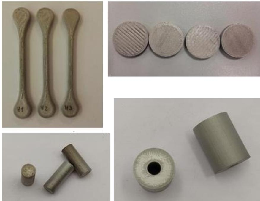
Figure 67. Éprouvettes de traction construits à l'horizontale.
