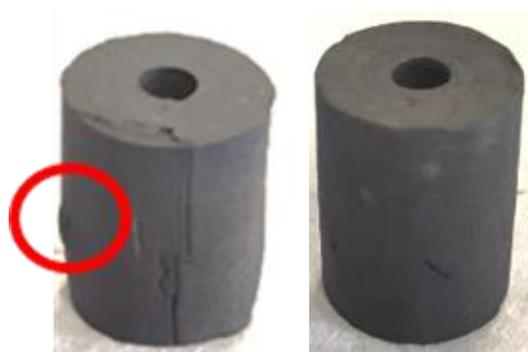
Figure 59 : Échantillons H13 après déliantage thermique (gauche) et après déliantage chimique + déliantage thermique (droite).
