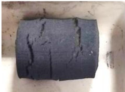
Figure 57 : Échantillons H13 après déliantage avec une rampe de montée en T°C de 1 °C/min
