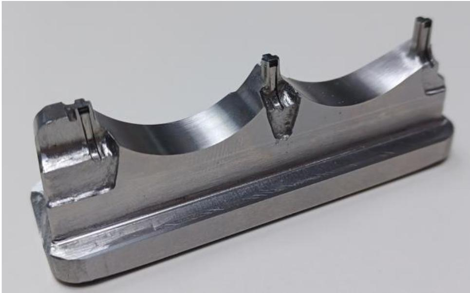
Figure 34 : Géométrie finale de l'insert L-PBF, après finition
