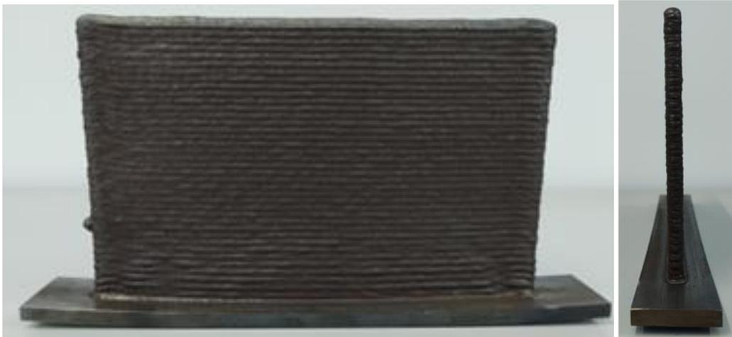
Figure 14 : Mur fabriqué
