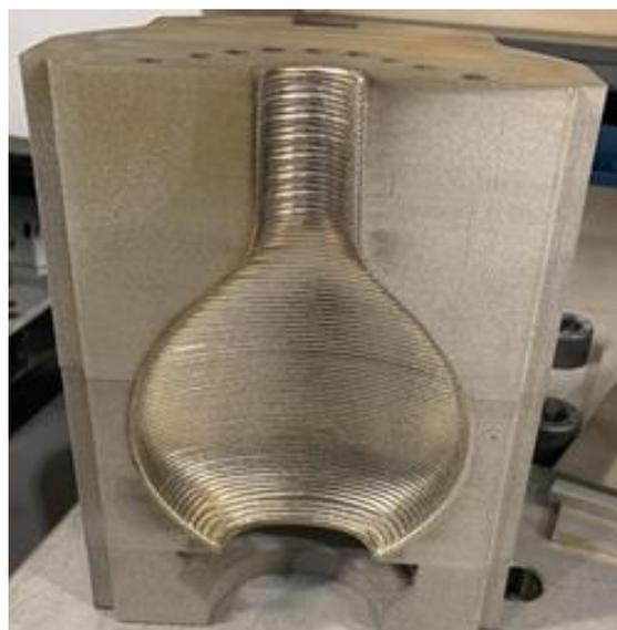
*Figure 84 : Moule après dépôt par DED-PL*
