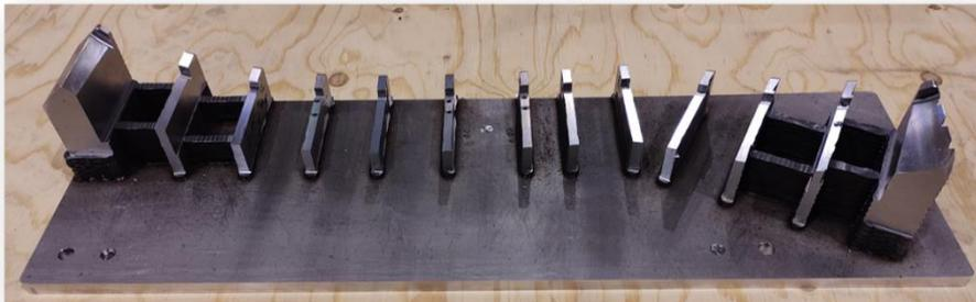
Figura 24. Mecanizado de las zonas críticas del demostrador.
