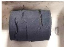
Figura 57. Muestra de H13 con un calentamiento de 1 °C/min.
