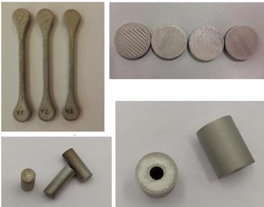
*Figura 67. Muestras para la caracterización de tracción, microestructural, dilatometría y tras tratamiento por HIP.*
