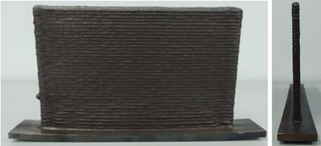
Figura 14. Pared fabricada para caracterización.
