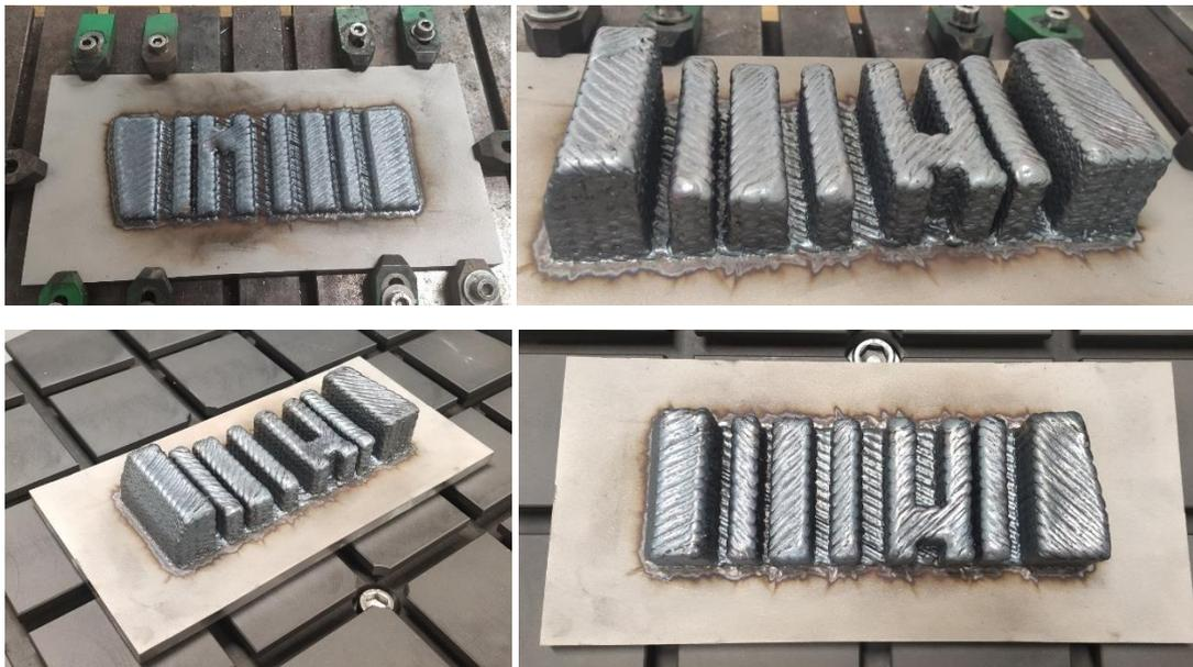
Figura 8. Fabricación de la pieza cercana a la final con DED hilo láser.
