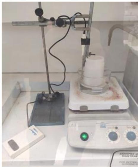
Figura 60. Set up del laboratorio para el eliminado químico del ligante.
