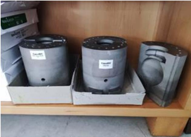
*Figura 78. Molde fabricado por L-PBF.*
