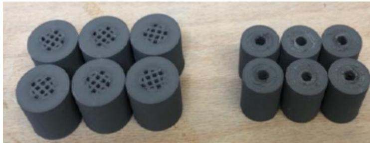
*Figura 55. Muestras para mejorar el eliminado del ligante y sinterizado.*
