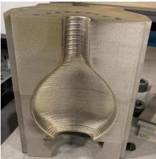
*Figura 79. Interior del molde tras la deposición por L-DED.*
