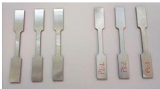
Figura 19. Posición y geometría de probetas de tracción ASTM E8 extraídas del muro WAAM.
